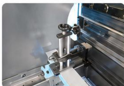
Tope trasero de dedos con ajuste fino de alta precisión
